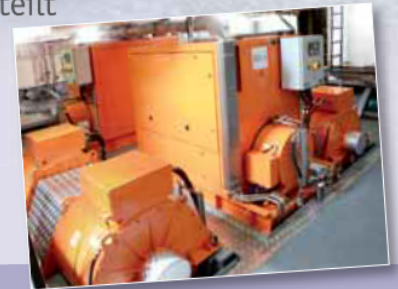
Ansicht des aktuellen Torque Antriebssystems auf dem GMS ENOK mit Torque Fahrmotoren und geräuschgekapselften Diesel-Generatoren in Modulbauweise
